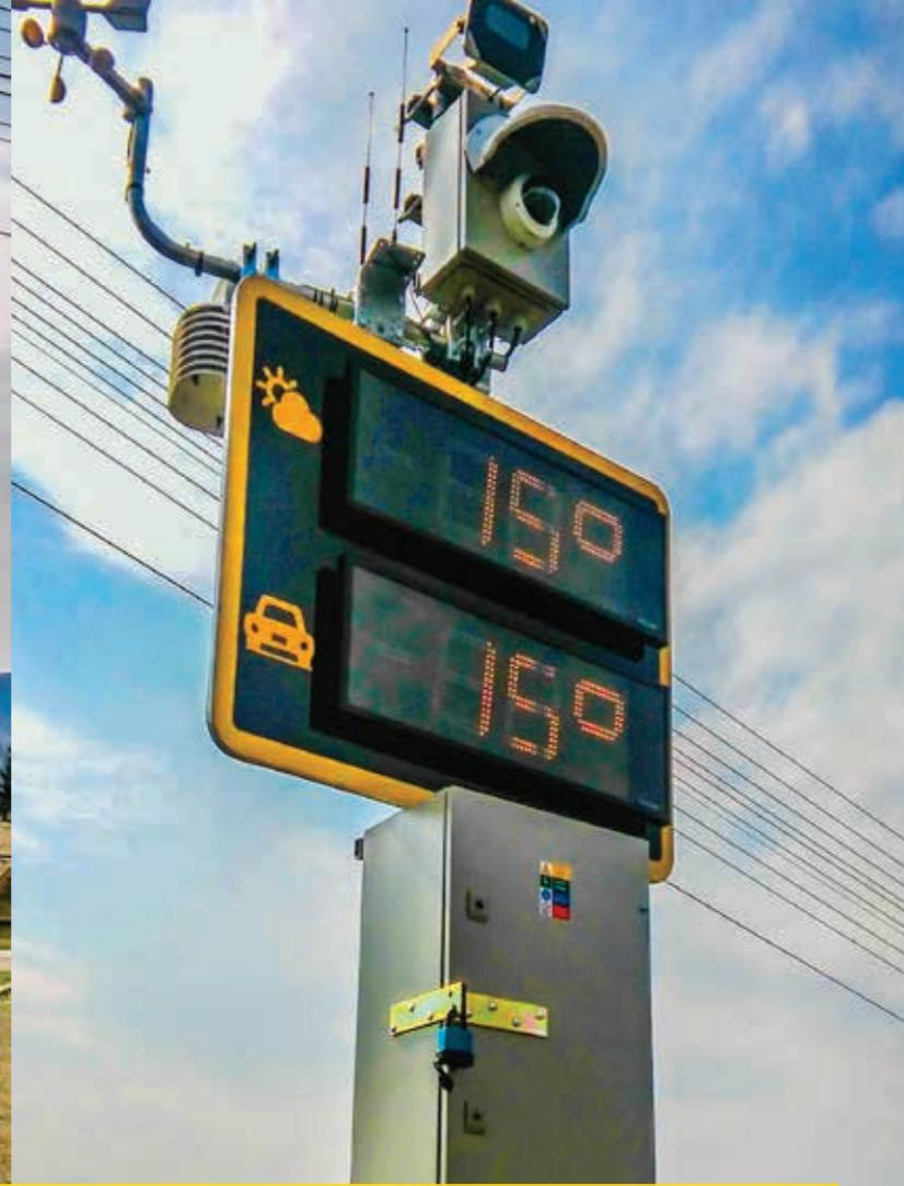
Dispečer z meteostaníc získava údaje o aktuálnej teplote vozovky, teplote vzduchu, relativnej vlhkosti, rosnom bode, smere a rýchlosťi vetra, ktoré zaznamenávajú jednotlivé snímače meteozáriadenia.
